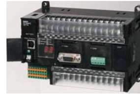
Omron C/CV/CS/CJ/CP 系列 HostLink 9 针 D 形公头
